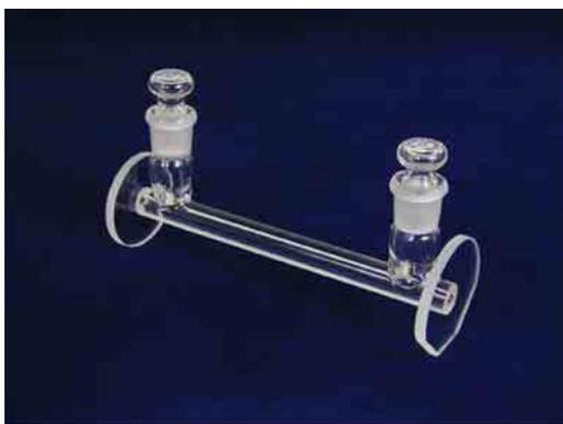
Fig. 1  $\phi$  2.5mm x 100mm cell
